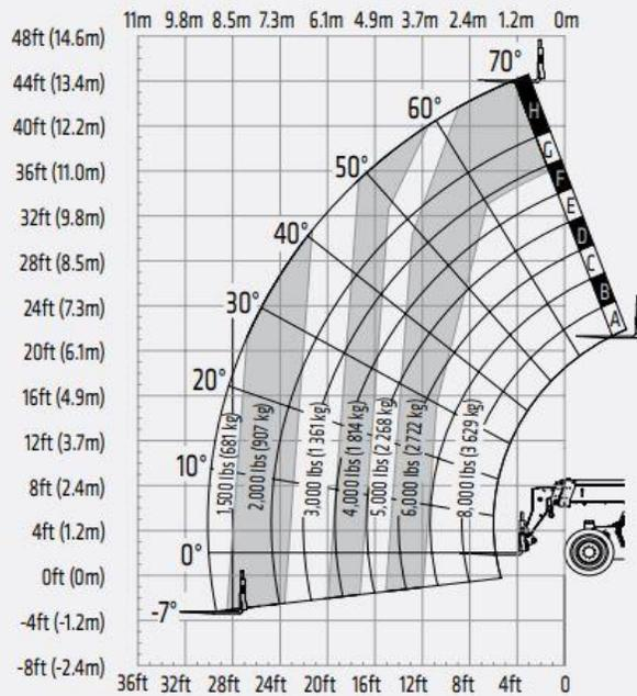
ATTENTION: la capacité de charge d'un chariot élévateur est toujours calculé à 24" à partir du tablier (dos de la fourche).
