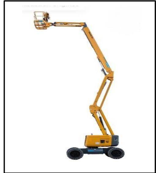
\* 12 batteries de 6 volts (435AH), chargeur et possibilité de recharger les batteries avec moteur diesel
