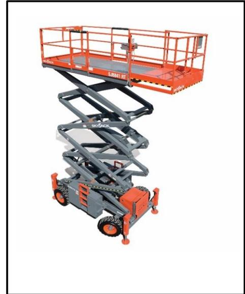
\* Garde corps repliable 88" lorsque abaissé
