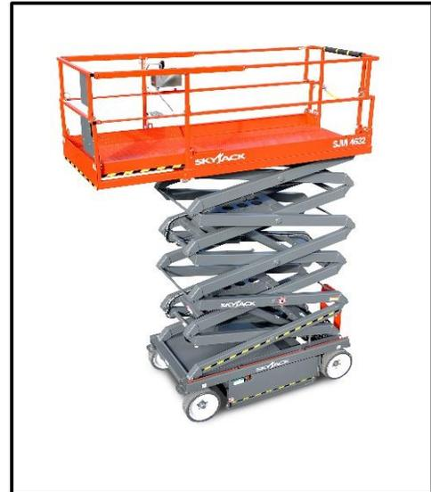
\* Garde corps repliable 74" lorsque abaissé
