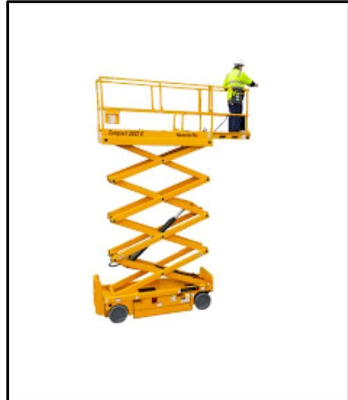
\* Garde corps repliable 52" lorsque abaissé
