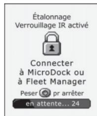
4. Lorsque l'écran suivant s'affiche, fixez le capuchon d'étalonnage et injectez le gaz d'étalonnage à un débit de 250 à 500 ml/min. **Raccordement de la bouteille de gaz au détecteur, page 8.**
