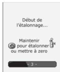
3. La fonction de mise à zéro du détecteur s'exécute. L'indication **zeroing** (mise à zéro) s'affiche pendant que le détecteur procède à la remise à zéro des capteurs.
